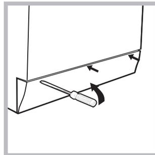
1. verwijder het afdekpaneel aan de voorkant van de wasdroogmachine met behulp van een schroevendraaier (zie afbeelding);
